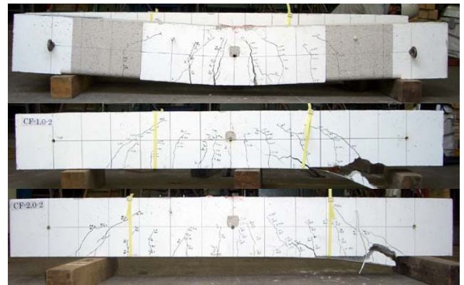
図 3.1 最終破壊状況
