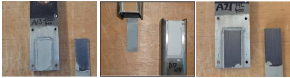
試験 A 高強度 試験 B 高強度 試験 A 中弾性 写真-3 接着面の破壊状況
